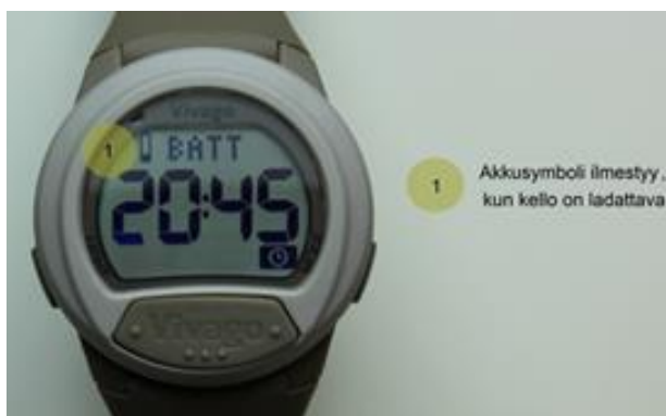
Figur 7. Vivago CARE -klockan visar en batterisymbol när batteriet är nästan tomt.
